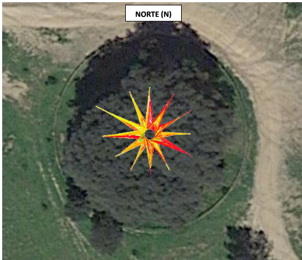
Imagen 20. Representación del sistema radical obtenido en la tomografía colocado a escala en la en foto aérea de Google Earth.
