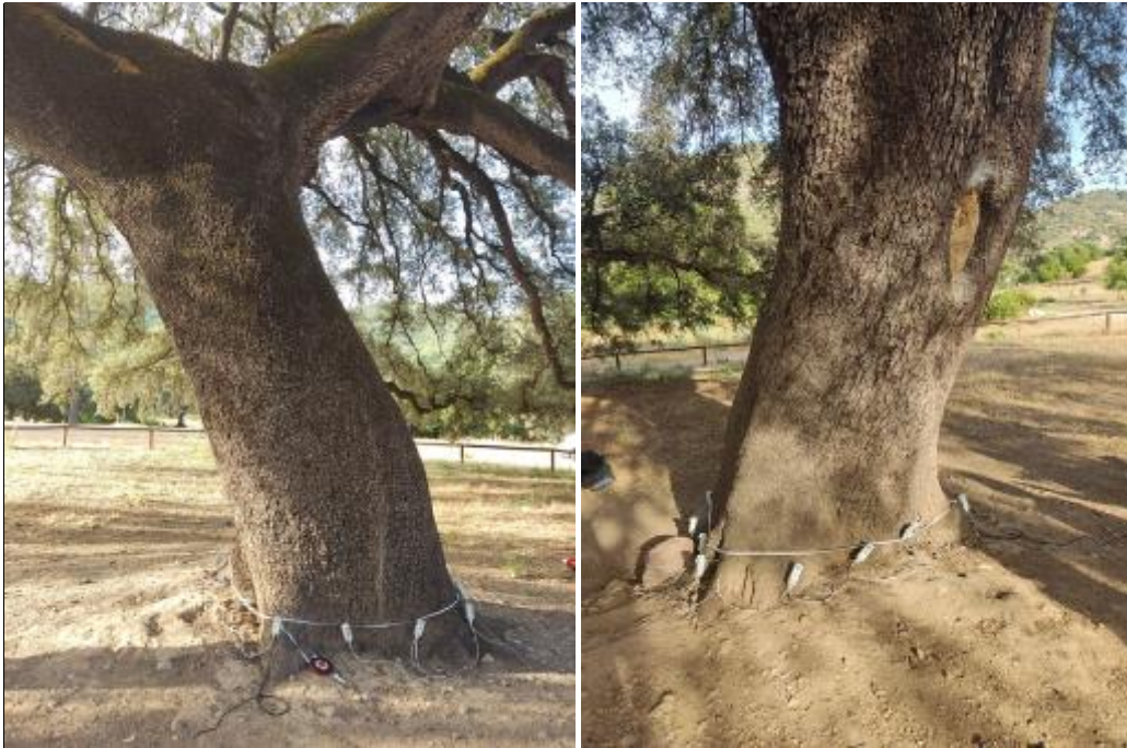
Imagen 18. Situación de los sensores para la realización de tomografía en la base.
