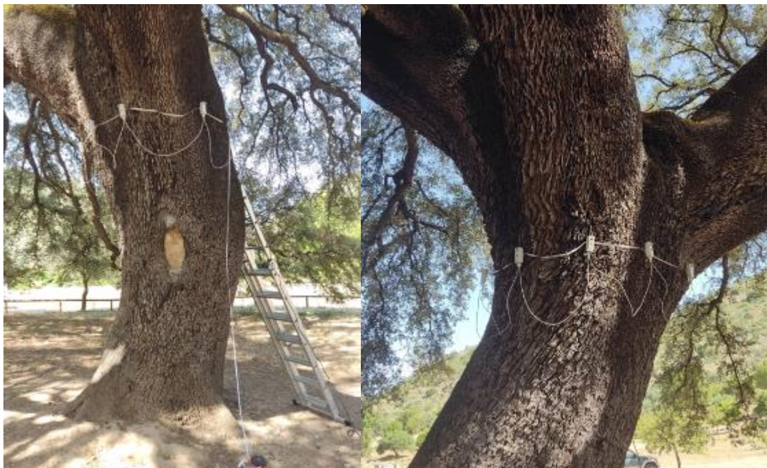
Imagen 17. Situación de los sensores para la Realización de tomografía debajo de la cruz.
