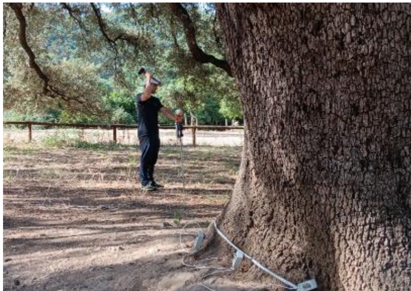
Imagen 19. Medición realizada durante tomografía de raíces.
